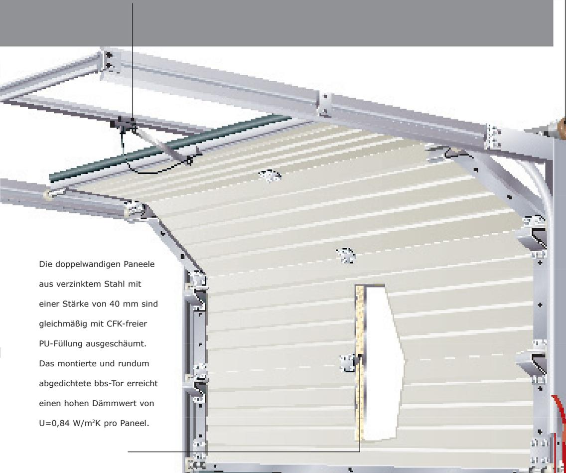
Die doppelwandigen Paneele aus verzinktem Stahl mit einer Stärke von 40 mm sind gleichmäßig mit CFK-freier PU-Füllung ausgeschäumt. Das montierte und rundum abgedichtete bbs-Tor erreicht einen hohen Dämmwert von  $U=0,84 \text{ W/m}^2\text{K}$  pro Paneel.
